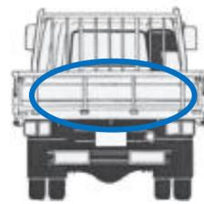
リヤアオリ 傷、凹み、下段ロック欠品 内張 凹み穴、リベット穴
